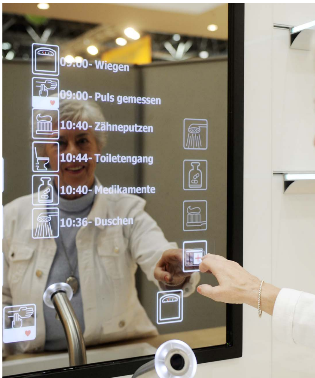
Teil eines intelligenten Badezimmers des Fraunhofer-inHaus-Zentrums Duisburg: Ein Spiegel als Touchscreen erinnert am Medikamente und ans Zähneputzen. Foto Messe Düsseldorf
